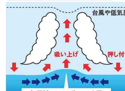
台風や発達した低気圧の中心が接近すると、中心付近の気圧が低下し、海面が吸い上げられて上昇します。
