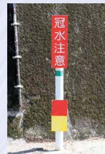
▲道路脇に設置された量水標
