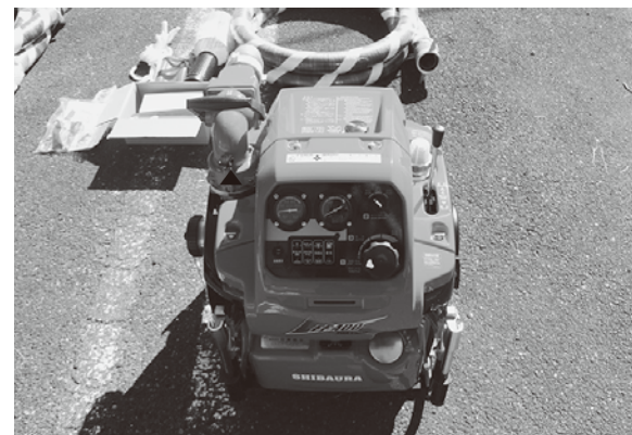
▲小型動力ポンプ
