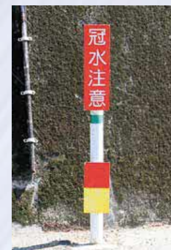
▲道路脇に設置された量水標
