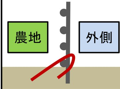
継ぎ目は1マス分重ねて設置をし、強度を上げるために、一番下は必ず結束線を付ける
