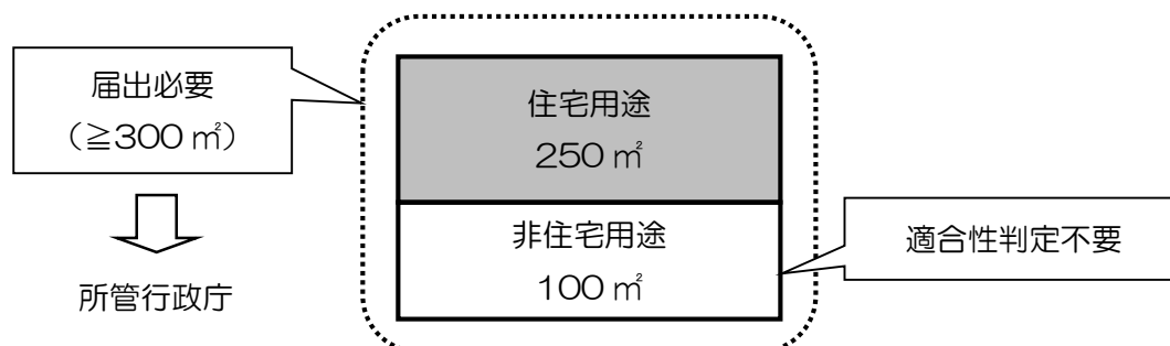
図 1-5-6 住宅用途・非住宅用途複合建築物の例 3
