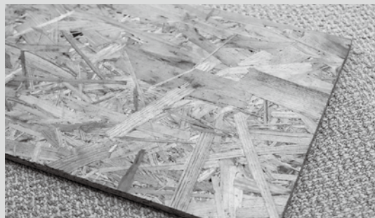
▲チップと接着剤を圧着してボードへ
